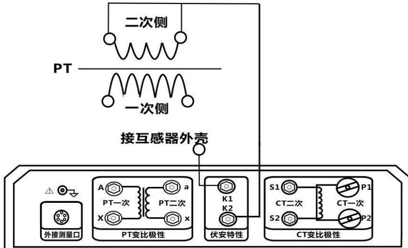
图 4.8 PT 交流耐压试验单机接线
