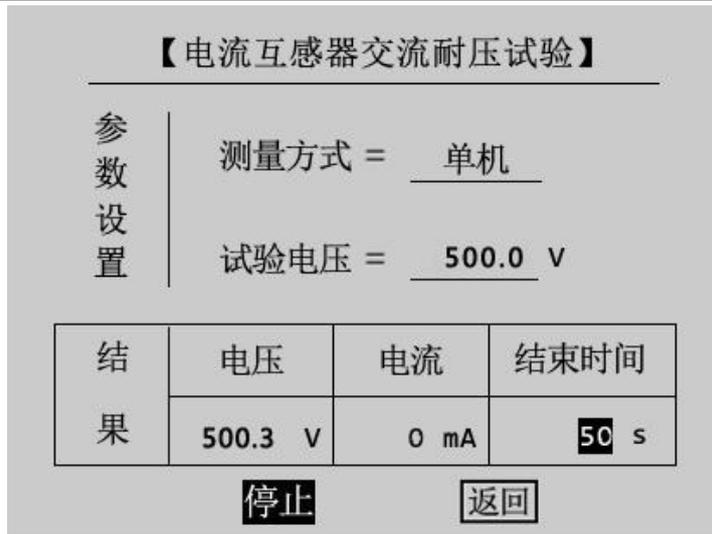
图 7.2 读取仪器显示电压界面
