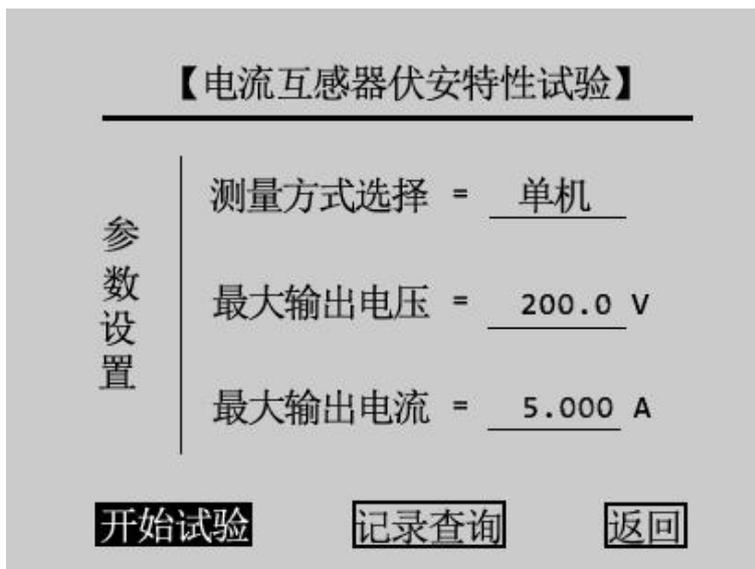
图 3.2 CT 伏安特性试验参数设置界面
