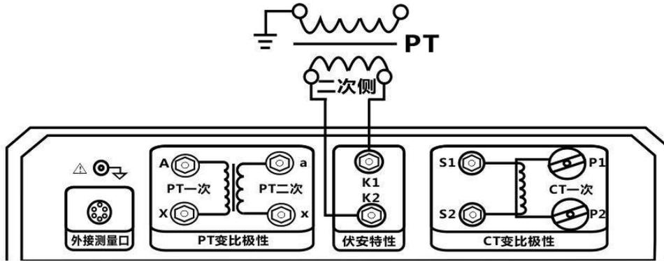
图 4.2 PT 伏安特性单机试验接线图
