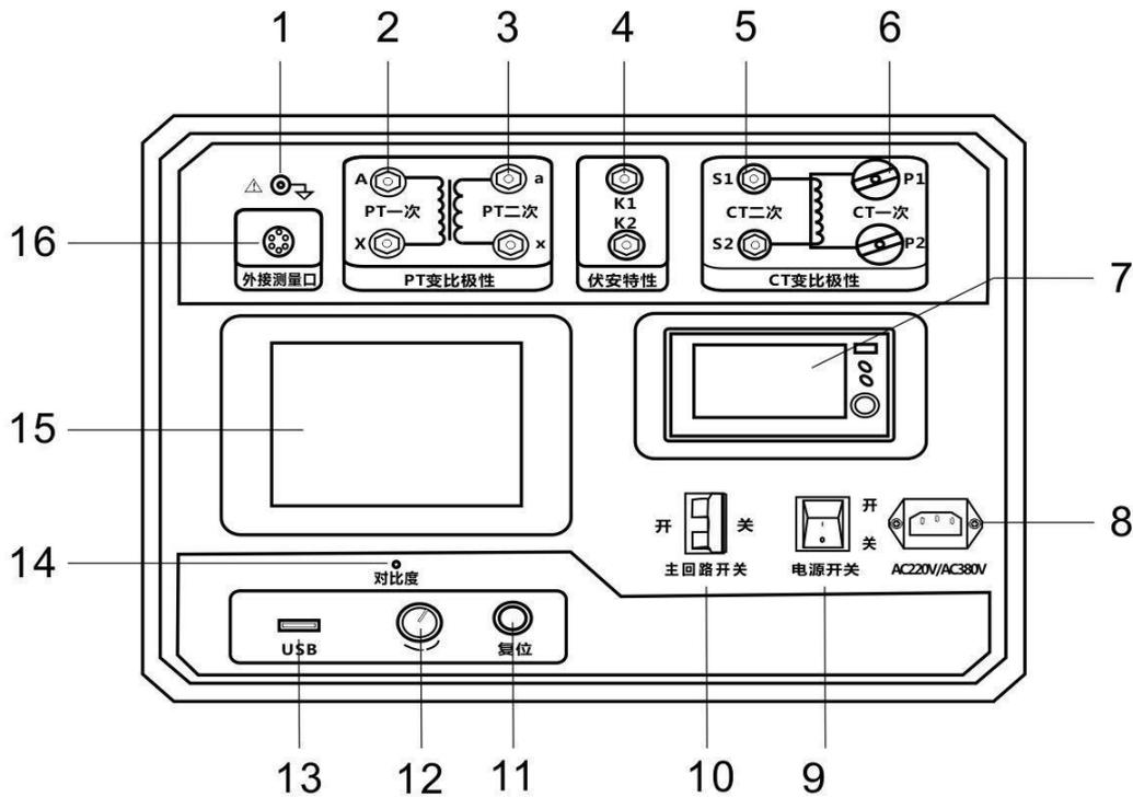
图 1.3 面板结构图
