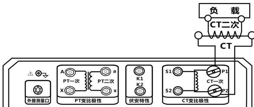
图 3.28 CT 一次通流试验接线
