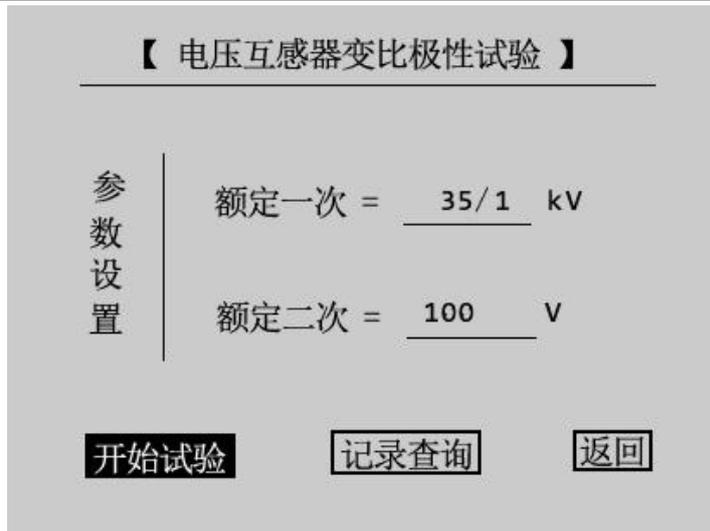
图 7.5 PT 变比极性试验参数设置界面
