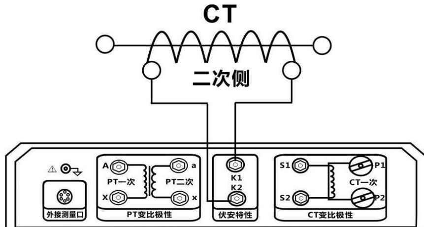
图 3.3 CT 伏安特性单机试验接线图
