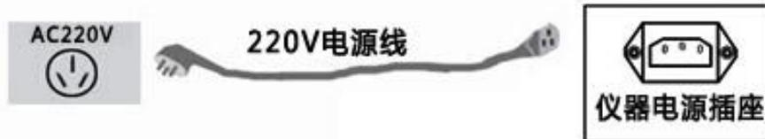
图 1.1 仪器 AC220V 电源供电接线图
