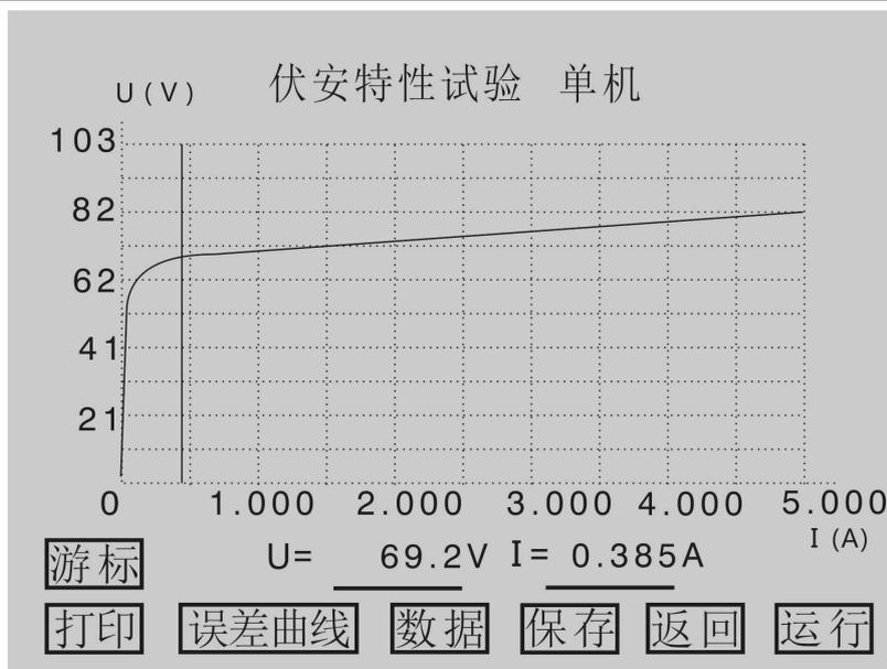
图 3.8 伏安特性试验结果游标操作界面
