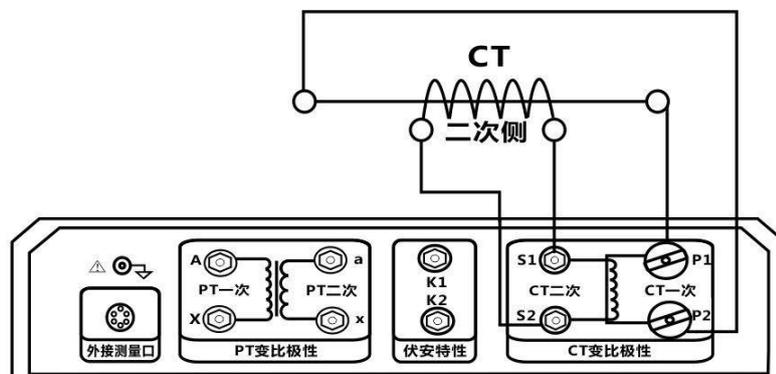
图 3.19 CT 变比极性试验接线
