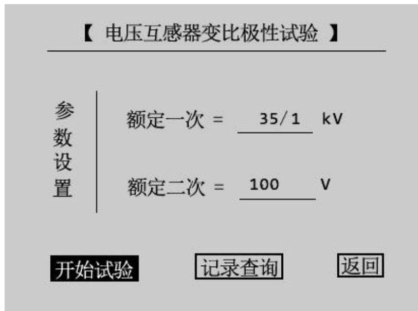
图 4.3 PT 变比极性试验参数设置界面
