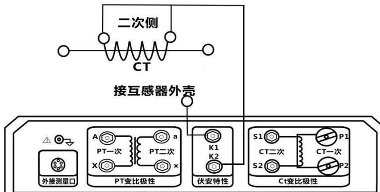
图 3.24 CT 交流耐压试验单机接线
