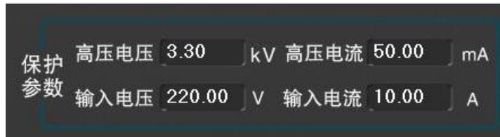
**高压电压 3.30 kV**: 变压器保护电压 (高压电压为被试品耐高压电压的 1.1 倍, 如被试品耐高压电压为 50KV, 则高压电压应设置为 55KV, 也可点击对话框手动设置)
